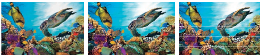
Tropfenposition nicht korrekt Überlappung / dunkle Streifen (Vorschub zu gering) Lücke / helle Streifen (Vorschub zu groß)
