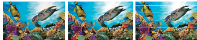
Fehlerhafte Tropfposition bei BIDI-Druck Überlappung / dunkle Streifen (Vorschub zu gering) Lücke / helle Streifen (Vorschub zu hoch)
